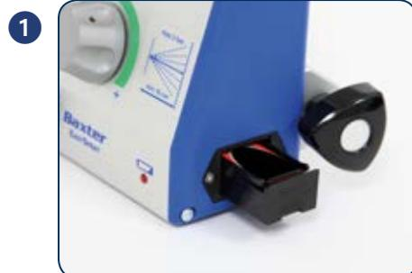
Vložte 9V baterii do regulátoru tlaku EASYSpray.
