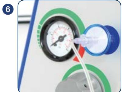
Zkontrolujte tlakoměr na zařízení EASYSpray, zda ukazuje správný rozsah tlaku 1,5–2,0 bara (21–28,5 psi). Upravte nastavení tlaku otočením černého ovladače pro regulaci tlaku.
