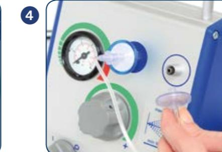
Připojte filtry sprejovací sady k zařízení EASYSpray. Připojte modře označený filtr k modrému konektoru typu luer s vnitřním závitem a neoznačený filtr ke konektoru typu luer s vnějším závitem.
